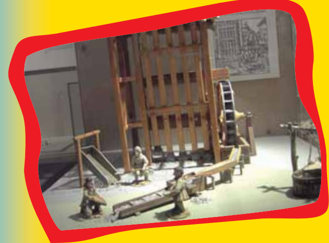
Das Wasser, das über das Wasserrad lief, setzte über eine Welle einen Querbalken in Schwung und brachte große Pochstampfer zum Stampfen. So wurden diese großen Brocken zerkleinert. Zum Schluss haben sie alles gesiebt. Sie haben die gesiebten Steine in Holzschüsseln geschöpft und im Kreis herumgeschwenkt, so dass die Steine heraus fielen und das Gold in den Schüsseln blieb.
